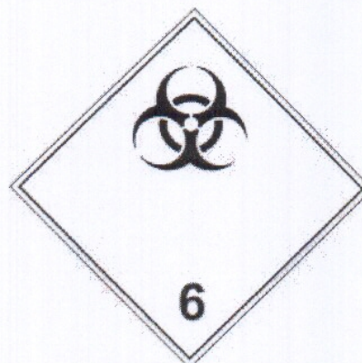
Зураг 1. Халдвартай хог хаягдал тээвэрлэх савны гадна талын таних тэмдэг
